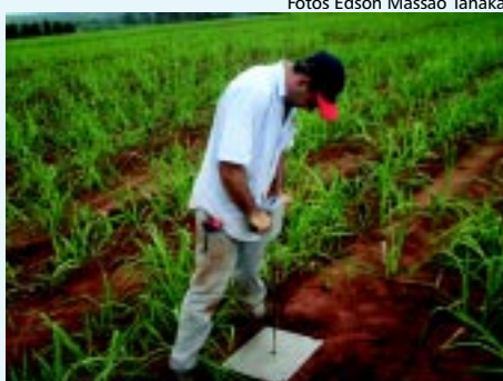
A densidade do solo foi determinada no perfil de 0,0m a 0,40m, através de coleta de dados com penetrômetro
