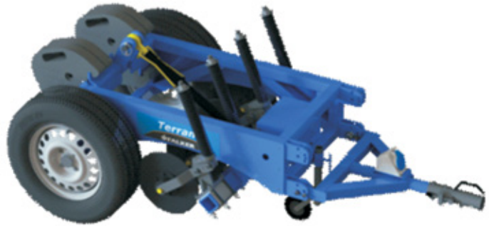
Figura 1. Medidor comercial de condutividade elétrica do solo Terram, da Falker Automação Agrícola LTDA.
