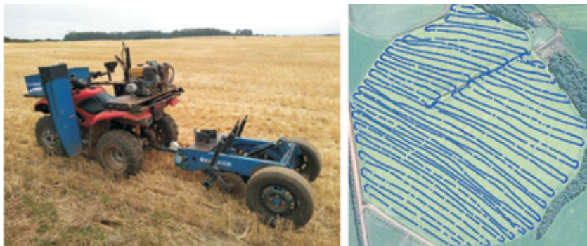
Figura 2. Conjunto quadriciclo e Terram (a) e mapa de pontos de leitura da CE do solo (b).
