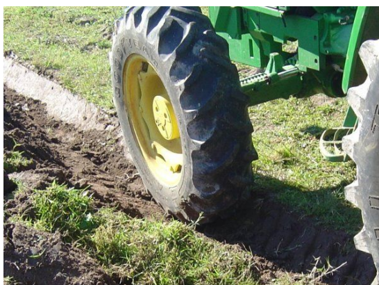
Figura 4: Pneus mal calibrados sobre solos úmidos formam uma perfeita combinação para compactar o solo.
