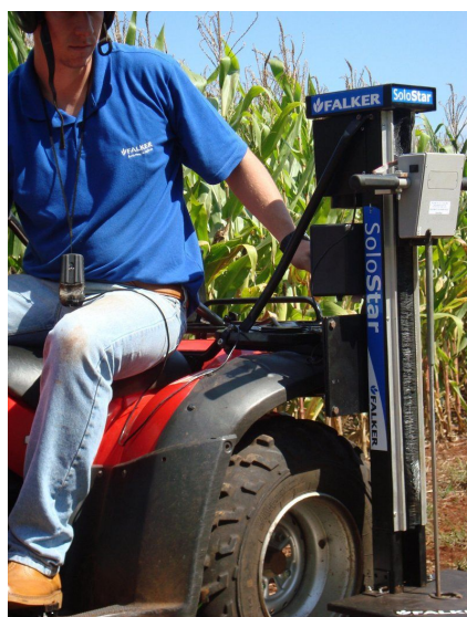
Figura 1: SoloStar, a solução da Falker para medição de compactação do solo em grandes áreas.
