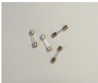
Figura 3: Fusíveis de reserva
