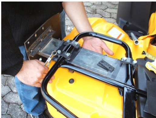
Figura 15: Chapas de fixação prendendo a Estrutura de fixação
