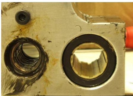
Figura 45: Detalhe da bucha gasta
