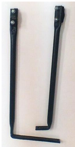
Figura 9: Tirantes inferiores de fixação (dianteiro e traseiro)
