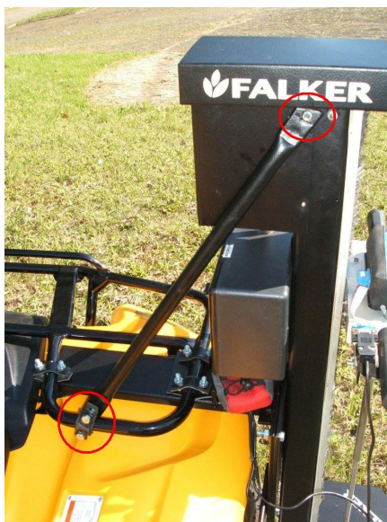
Figura 23: Fixação do tirante dianteiro
