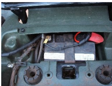
Figura 27: instalação da bateria concluída
