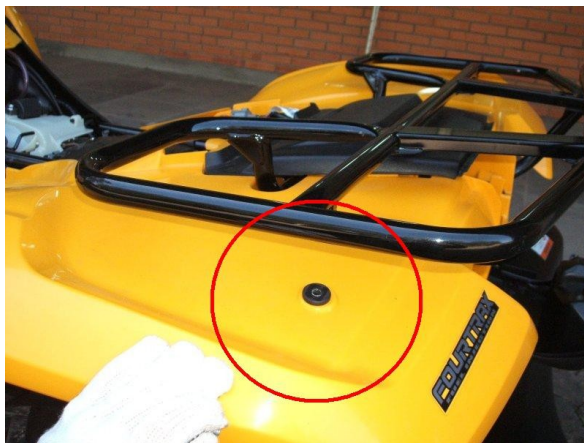
Figura 12: Detalhe do parafuso que prende a carenagem.
