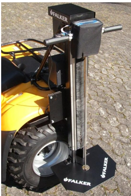
Figura 21: Detalhe do SoloStar preso na estrutura
