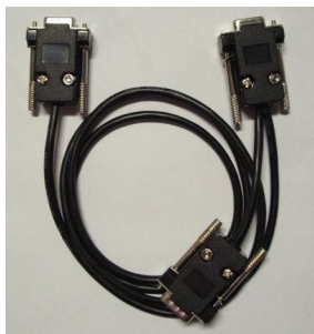
Figura 10: Cabo serial para ligação com penetroLOG e GPS
