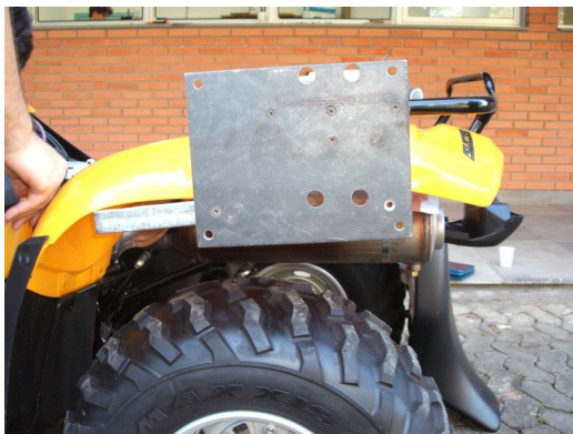
Figura 20: Detalhe do ponto de fixação do SoloStar
