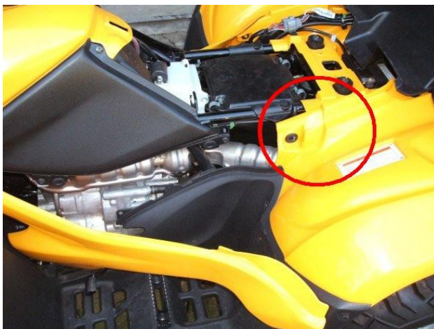
Figura 16: Detalhe do local de fixação do tirante inferior dianteiro
