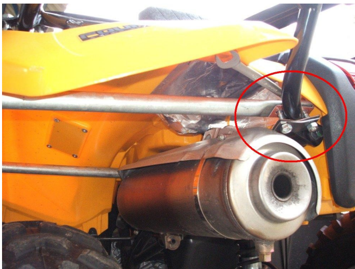
Figura 19: Detalhe do tirante inferior traseiro, fixado.
