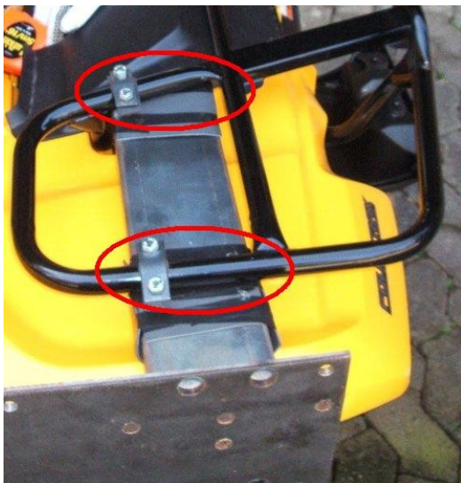
Figura 14: Detalhe do encaixe da estrutura no quadriciclo. (parte superior)
