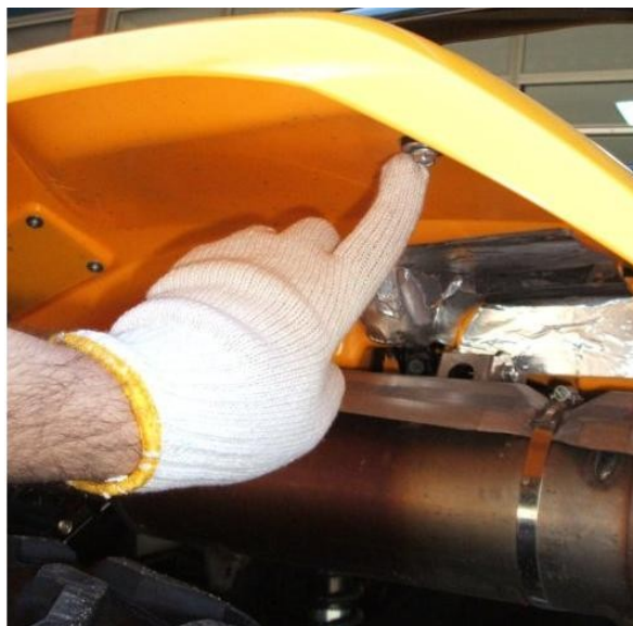
Figura 13: Parafuso que libera a carenagem.
