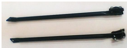
Figura 7: Tirantes superiores de fixação
