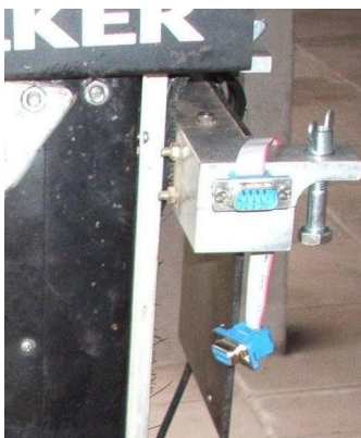
Figura 30: Detalhe do suporte de fixação do penetroLOG, com cabo extensor serial e parafusos e borboletas pré-fixados
