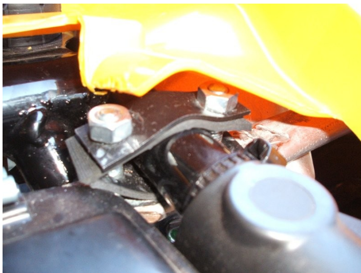
Figura 18: Detalhe do tirante inferior dianteiro fixado
