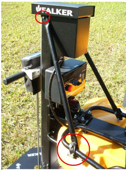
Figura 22: Fixação do tirante superior traseiro
