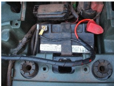
Figura 28: ligação da alimentação na bateria
