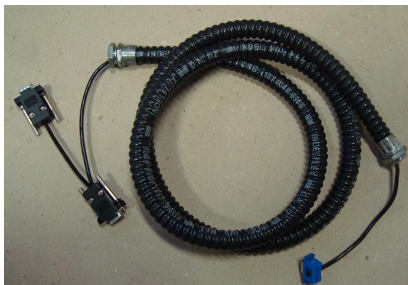
Figura 5: Cabos de comunicação com GPS e módulo eletrônico
