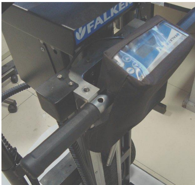
Figura 38: Alinhe os furos e prenda o módulo eletrônico de medição através de parafusos e porcas borboleta
