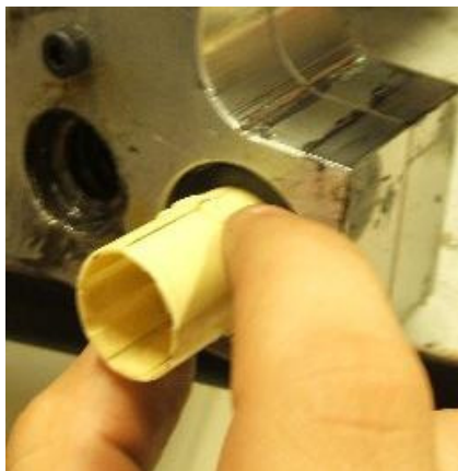
Figura 46: Soltando o refil da bucha Figura 47: Colocando novo refil
