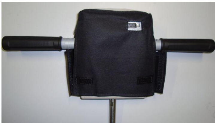
Figura 37: Módulo eletrônico de medição com capa protetora, laterais abertas.
