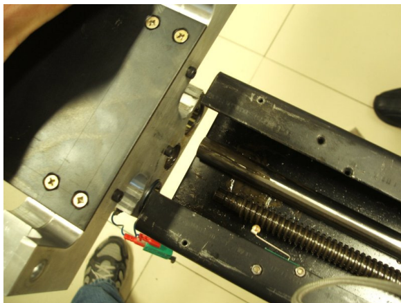
Figura 44: Retirada do suporte do módulo eletrônico de medição
