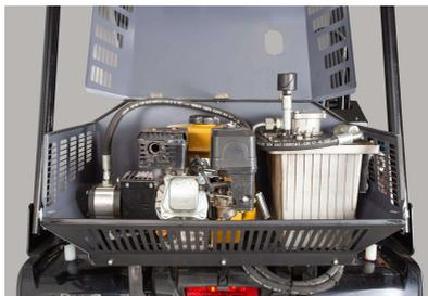
Figura 4: Unidade hidráulica
