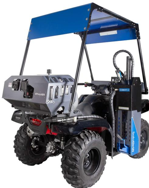
Figura 2: SoloDrill instalado em quadriciclo
