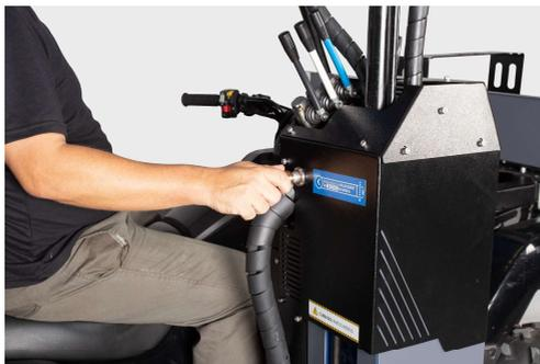
Figura 11: válvula de regulação da velocidade de descida da broca
