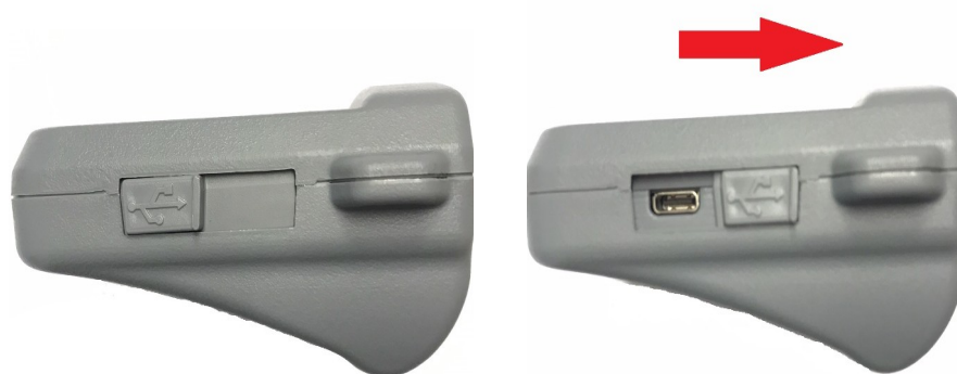
Figura 28: Acesso aos conectores
