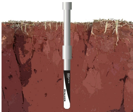
Figura 10: Sensor e extensor instalados e prontos para medição.
