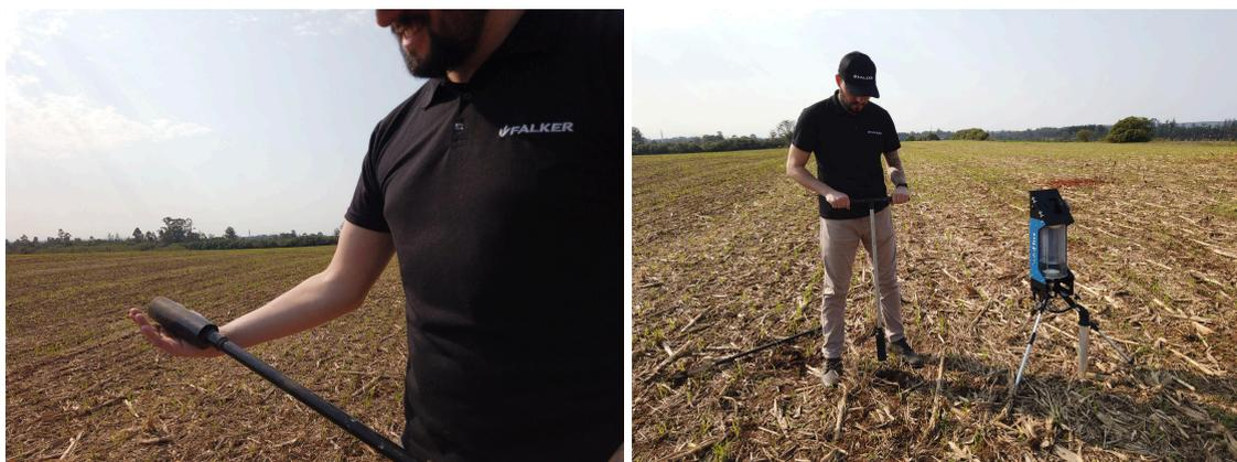
Após, desacople o trado caneca e fixe a escova na haste de fixação mais curta. Insira no poço e realize movimentos verticais, ou seja, na direção do poço, para desobstruir os poros e reduzir o espelhamento das paredes laterais, em especial nos solos argilosos ou muito argilosos.
