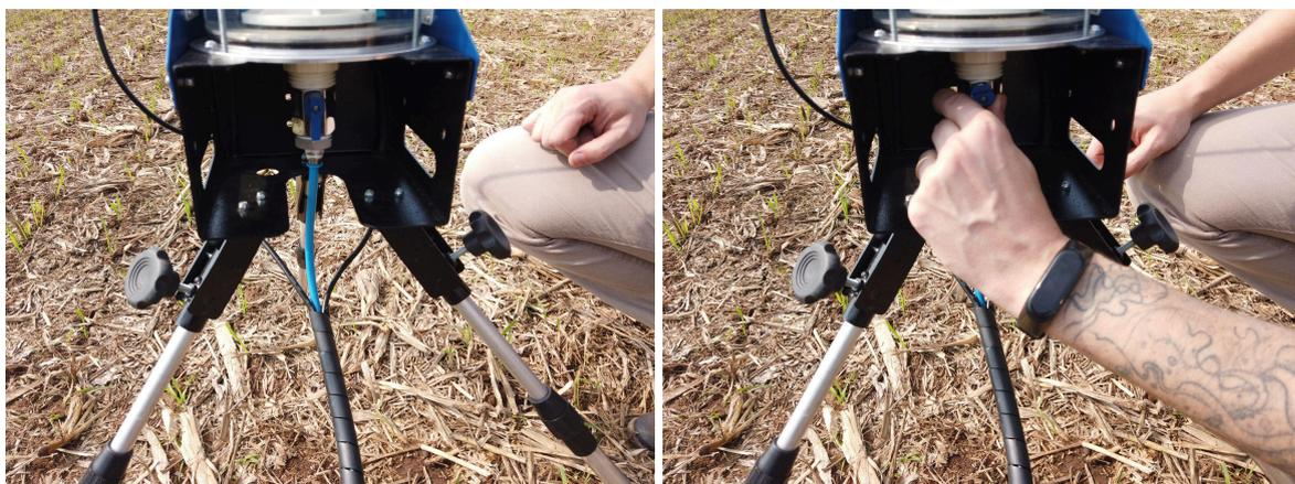
Abra a tampa frontal superior, retire a rolha do bocal de enchimento, e encha o reservatório com água até o limite inferior do bocal, evitando transbordamento. Após, insira a rolha novamente no bocal de enchimento, garantindo a vedação total da abertura.
