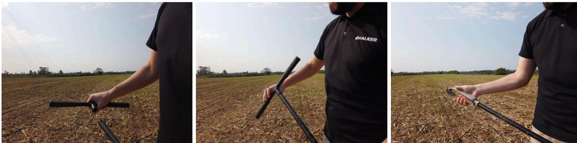
Posicione o trado holandês de maneira perpendicular ao solo ou verticalmente em caso de inclinação perceptível na presença de terreno ligeiramente inclinado.
