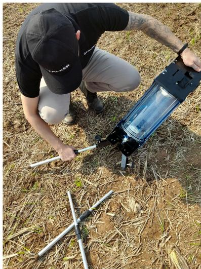
Com estrutura montada, acople o conjunto de medição ao conector correspondente, iniciando pela conexão hidráulica e posteriormente pelos demais conectores garantindo que os cabos se encaixem perfeitamente, atentando-se além da conexão dos pinos, ao encaixe completo da estria lateral.
