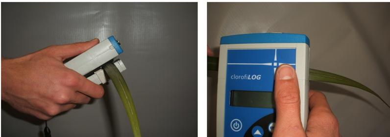
Mantenha a câmara de medição fechada por 2 segundos, até que o equipamento emita dois alertas sonoros de curta duração, indicando que a medição foi realizada. Libere a câmara para que volte a sua posição inicial.
